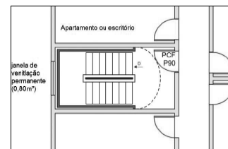
Figura 7 - Escada enclausurada protegida
