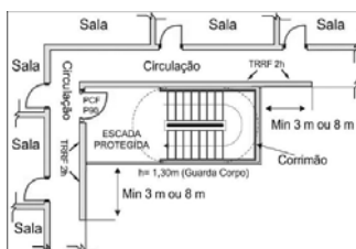
Figura 14 – Escada aberta externa
