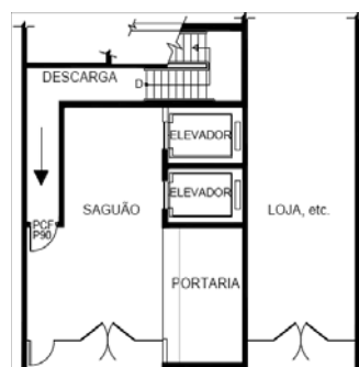
Figura 20 – Descarga através de hall térreo não enclausurado
