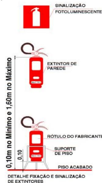
Figura 1 – Fixação do extintor
