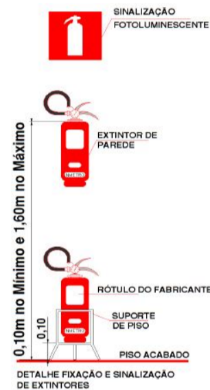
Figura 1 – Fixação do extintor
